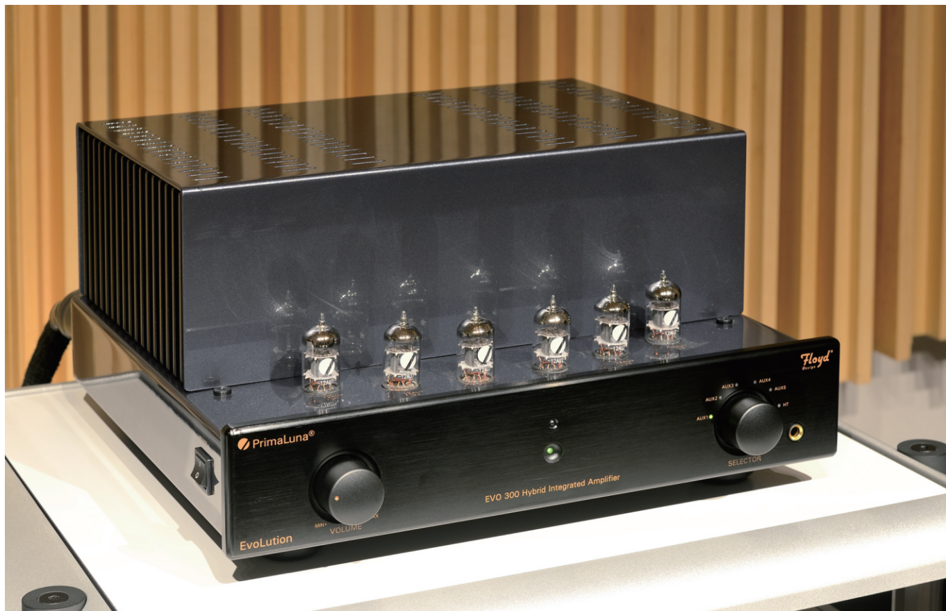
▲ EVO 300 Hybrid采用了6只12AU7，其中2个用作输入缓冲、4个用作前级放大
